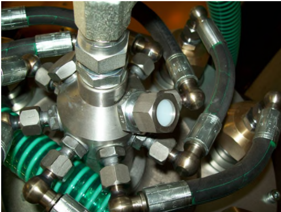
Fig. 2 (Burst disc holder showing “White” burst disc.)
